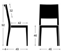
Handwerk und zeitgenössische Technik vereinen sich bei diesem stapelbaren Holzstuhl mit langer Rückenlehne. Während die verwundenen Hinterbeine mit der Technik des Flankenschnitts hergestellt werden, sind die Verbindungen am Rahmen stabil gezapft und geleimt. Zusätzlich werden die Verbindungen mit Schrauben an der Unterseite des Sitzes noch verstärkt, sodass trotz der filigranen Erscheinung und des geringen Gewichts eine hohe Belastbarkeit des Stuhls gewährleistet wird.
