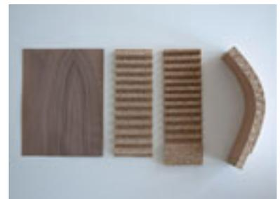
Abb. 3: «Recoflex» ist ein Verbundwerkstoff aus Holz-, Kork- und Latexpartikeln. Es ist ziemlich elastisch, wird aber steif, sobald Furniere aufgeleimt werden. ETH RAPLAB, Zürich, Juli 2010 (Foto: Christoph Schindler)
