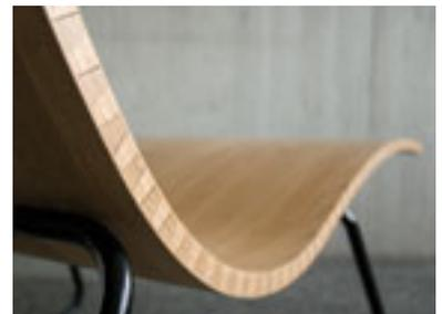
*Abb 1: Ein Zip-Shape Formstück besteht aus zwei Platten, die so gezinkt werden, dass sie nur in der gewünschten Krümmung zusammenpassen. Die «ZipChaise» besteht aus massiver stabverleimter Eiche mit einer Materialstärke von 20 mm. Schreinerei Bach Heiden mit Schilliger Holz AG Küssnacht am Rigi, Juli 2007 (Foto: Christoph Schindler)*
