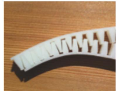
Abb. 9: «KlickZip»-Muster aus thermoplastischem ABS aus dem 3D-Drucker Detmolder Schule für Architektur und Innenarchitektur in Zusammenarbeit mit der University of Florida, Mai 2011
