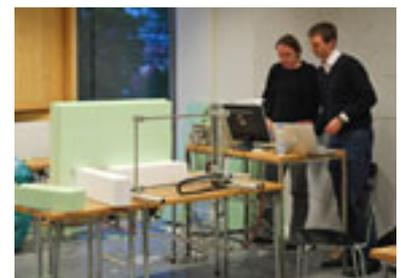
*Abb. 5: Der von der Step Four GmbH zur Verfügung gestellte CNC-Heißdrahtschneider ist in der Lage, jede Regelfläche zu bearbeiten. Detmolder Schule für Architektur und Innenarchitektur in Zusammenarbeit mit der University of Florida, Mai 2011 November 2010 (Foto: Ulrich Nether)*
