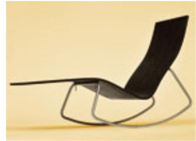
*Abb. 4: Die «ZipLiege» besteht aus einem 18 mm Recoflex-Mittellage mit aufgeleimten Eschenfurnieren. Die Form wurde von Körpermassen abgeleitet. Sie wurde 5-achsrig gesägt in der Schreinerei Schnidrig in Visp und vakuumverleimt an der BFH-AHB in Biel. Designers' Saturday 2010, Langenthal, November 2010 (Foto: Kyeni Mbiti)*
