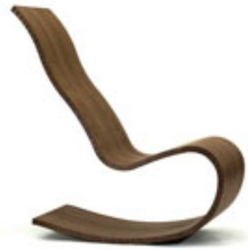
Abb. 2: Der «Ziprocker», entwickelt mit R. Aimer, K. von Felde, O. Illner, S. Rehders, T. Schütt und H. Wolf, ist ein auskragender Schaukelstuhl mit einer Gesamtmaterialstärke von 30 mm, zusammengesetzt aus einer Fichten-Mittellage mit Nussbaumfurnier-Deckschichten. Die Form wurde von einem Autositz abgeleitet. Fachschule für Holztechnik Hamburg, Januar 2009 (Foto: Kyeni Mbiti)
